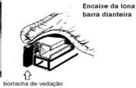
3-Coloque as barras laterais nos prisioneiros laterais, note que a frente já está parafusada nas barras laterais, prenda esta barra e agora pressione a barra dianteira contra caçamba e aperte os parafusos definitivamente, foto exemplo - mostrando a forma de prender para a borracha vedar a capota Fig.04
