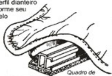
2 - Monte o quadro da capota na caçamba conforme a ilustração
