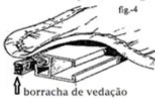
3-Coloque a borracha no perfil dianteiro após prender a lona.fig04
