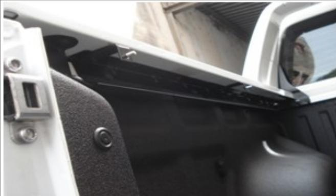
2-Encaixe a lona no perfil dianteiro, parafuse a barra dianteira nas barras laterais e coloque a borracha. A borracha que é colocada na barra dianteira, deve transpassar a barra em 8cm aproximadamente de cada lado e será colada na barra lateral, após prender as barras laterais, para que vede a lateral dianteira Fig.02 e 03.
