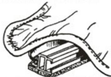
Detalhe do encaixe da frente da lona na barra dianteira (quadros de alumínio)
