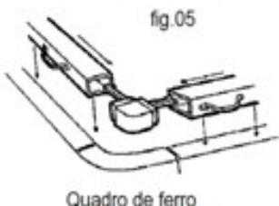
2-Coloque a lona no quadro, prenda-a completamente, observe que no perfil dianteiro o orifício redondo onde se prende a lona, fica para cima (fig06)
